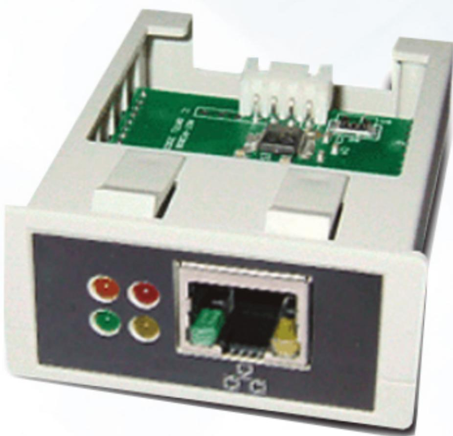
La tarjeta SNMP DY520 integra múltiples redes protocolos de comunicación para habilitar un Monitoreo y administración remotos completos, fáciles de entender y seguros para UPS y otros equipos a través de Internet.
