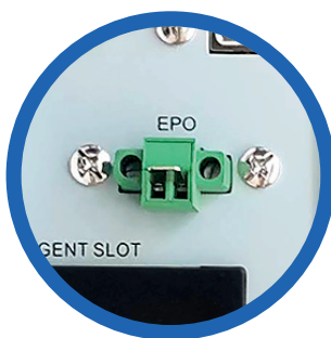
Apagado de emergencia (EPO)
