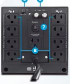
Cuenta con supresor de voltaje de alto desempeño que absorbe picos y corrige altas y bajas de tensiones de fluido eléctrico, el equipo tiene un dispositivo de retardo de encendido para proteger a sus electrodomésticos (microondas, refrigeradores y otros aparatos electrónicos) en lo que se estabiliza el suministro de energía.
