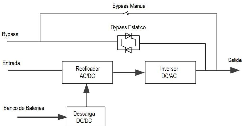
Fig. 2-5 Diagrama modo de operación en baterías
