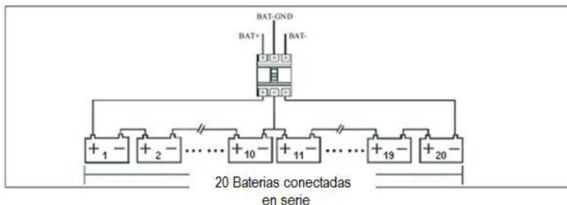
Fig. 3-13 Diagrama de conexión banco de baterías
