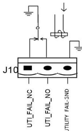
Fig. 3-27 Diagrama contacto secos falla de red
