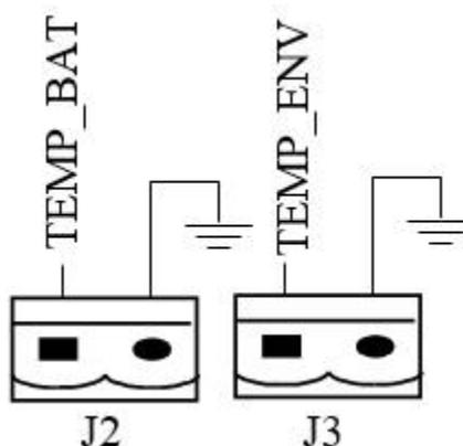
Fig. 3-21 Puertos J2 y J3 detección de temperatura
