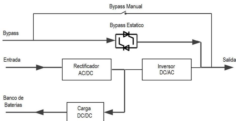
Fig. 2-6 Diagrama modo de operación bypass
