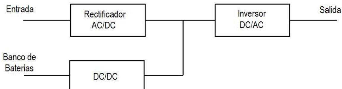
*Fig. 2-3 Estructura módulo de poder*
